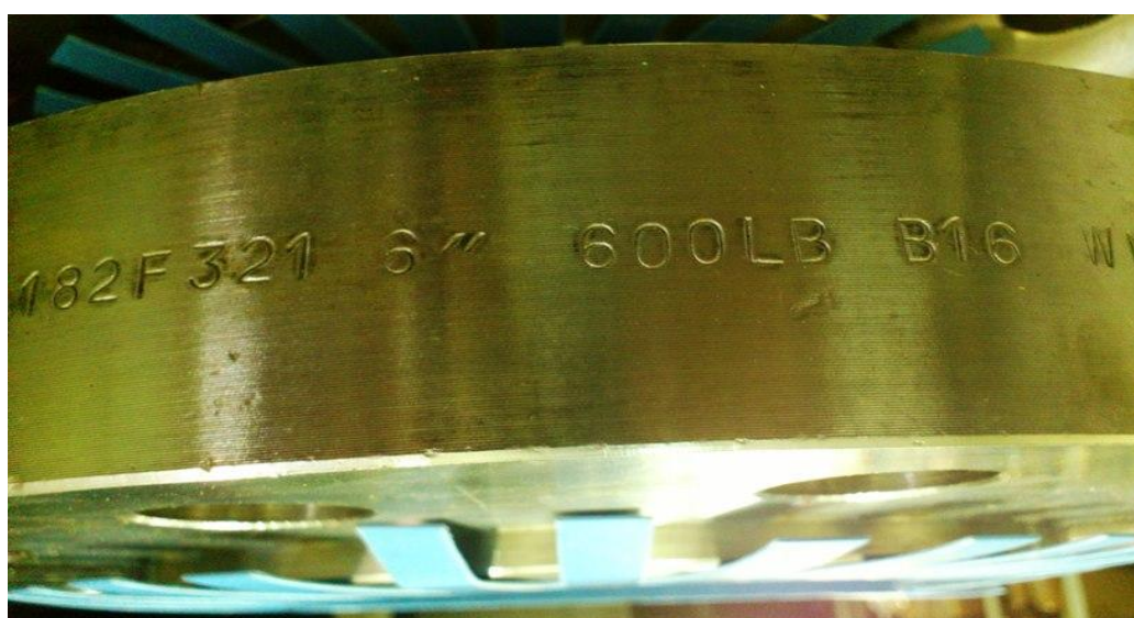
فلنج چینی به شکل لبه ها و ماشینکاری دقت شود .
