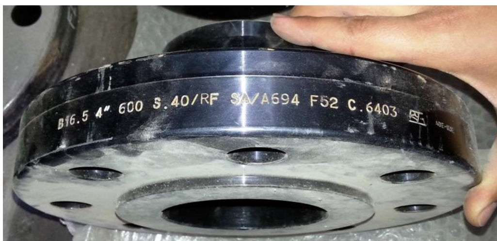
فلنج گالپرتی ایتالیا به لبه های منحنی و زبری ماشین کاری سطحی دقت کنید
