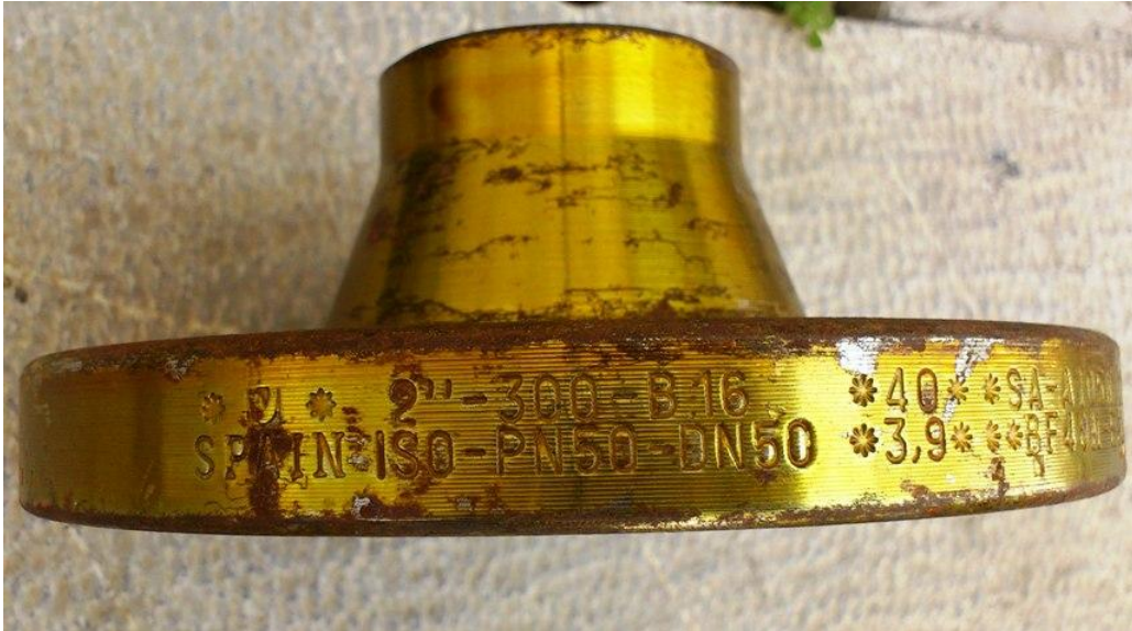
حک بالا مربوط به فلنج اسپانیایی ULMA است ، به مارکینگ دقت کنید در دو خط و دو استاندارد نوشته شده است این برند در بازار بسیار شناخته شده است و هنوز تقلبی آن دیده نشده ( با توجه به جزئیات مارکینگ تقلب آن دشوار است )
