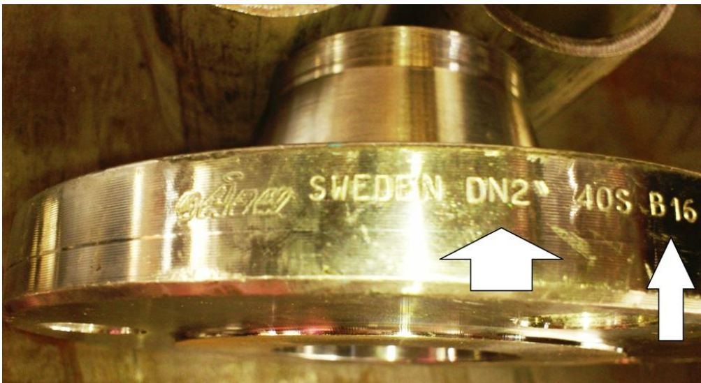
فلنج مذکور در استاندارد B16.5 مارک شده است ولی سایز آن به جای اینکه مطابق استاندارد ذکر شود 2" به اشتباه از سوی جاعل ذکر شده است DN2 که خود نشانه تقلبی بودن مارکینگ این فلنج است . ( 2" اینچ در استاندارد ISO ذکر میشود DN50 )
