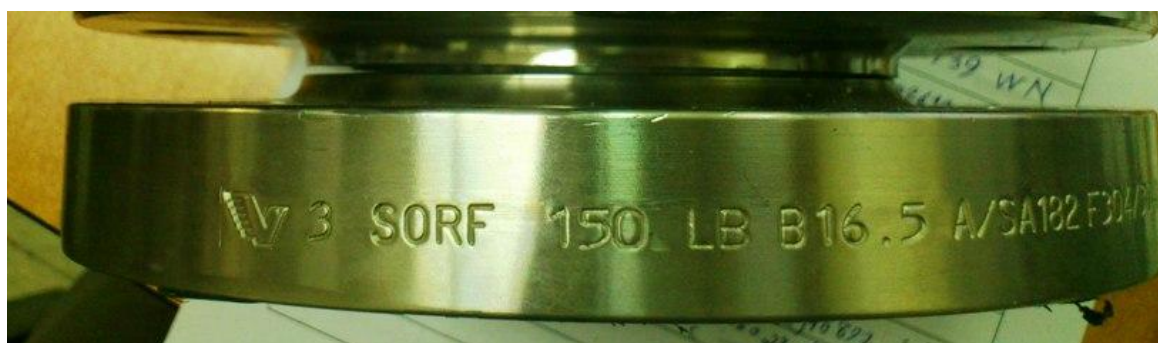
نمونه مارکینگ اصیل فلنج VIRAJ هند با لوگویی به شکل پرند
