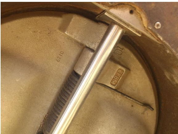
نمای پشت دیسک بدل - مارکینگ اجرا شده روی دیسک با کیفیت پایین
