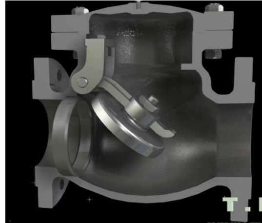
Seat در هنگام تعویض بدون باز کردن شیر از خط از طریق باز کردن سرپوش COVER خارج میشود.
