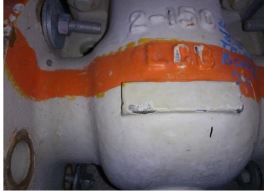
نمونه ای از رنگ یک شیر ایتالیا که از امارات وارد شده. خط نارنجی Color Code انبار امارات است
