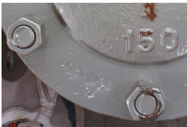
پیچ و مهره متفرقه فاقد مارکینگ از میلگرد آهنی معمولی - مردود
