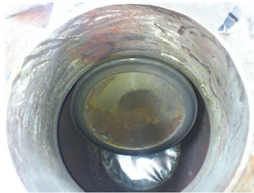
شیر بسیار سبک - پیچ و مهره ها نامرغوب و تک مهره- داخل جوشکاری تعمیری
