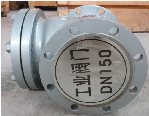
شیر بسیار سبک - پیچ و مهره ها نامرغوب و تک مهره- داخل جوشکاری تعمیری
