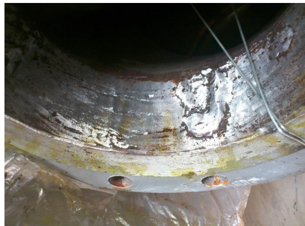
جوشکاری داخل برای اصلاح خوردگی تعمیری مردود
