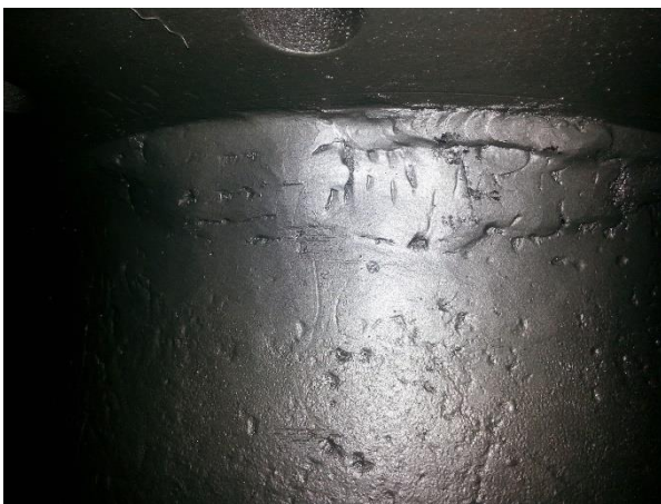
جوشکاری روی بدنه با کیفیت بسیار پایین
