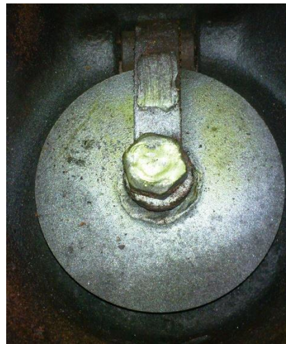
دو نمونه شیر چینی بی کیفیت (بسیار رایج) اتصال دیسک بالهیم و جوشکاری مردود - اتصال سر به بدنه Stud Bolt تک مهره
