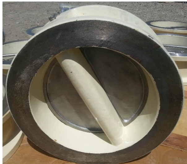
بدل: علامت مشخصه شرکت Goodwin روی دیسک ها وجود ندارد
