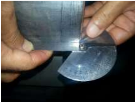
بررسی زاویه پخ اجرا شده در سر لوله با زاویه سنج
