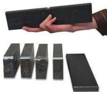
تصویر نمونه با اثر زخم فشاری بر لبه نمونه
