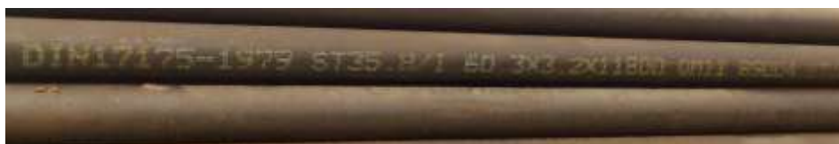
محصول چین فاقد برند در استاندارد DIN 17175 متریال ST35.8 سایز 60.3 میلیمتر
