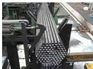
نمونه ای از دستگاه بسته بندی Hex agonal forms Bundle -
