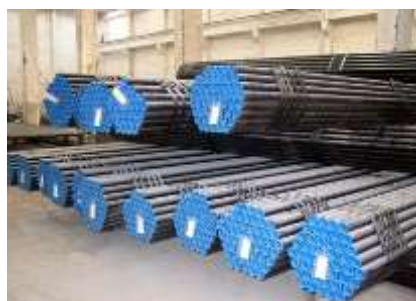
باندل با درپوش لوله و پلاک مشخصات برای لوله فولادی
