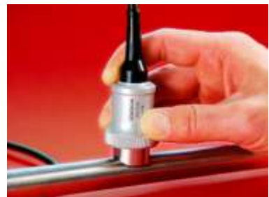
پروب ویژه با کفشک تماسی متناسب با انحنای یک سایز خاص از تیوب
