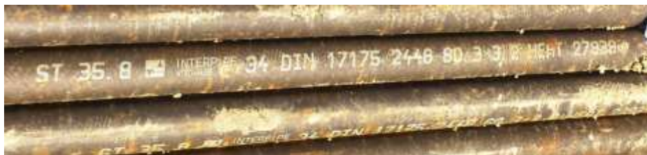
برند INTER PIPE در استاندارد DIN 17175 متریال ST35.8 سایز 80.3 میلیمتر
