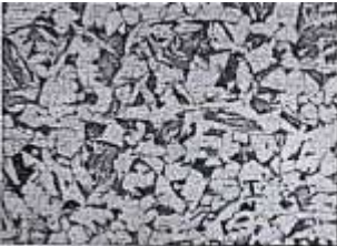
شکل 5. ساختار درشت دانه شامل بینایت، فریت و پدمنتشان و فریت سوزنی به همراه نواحی کوچک پرلیت در ناحیه HAZ نزدیک به جوش محلول ظاهر کننده: نایتال ٪2
