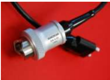
پروب ویژه با کفشک تماسی متناسب با انحنای یک سایز خاص از تیوب
