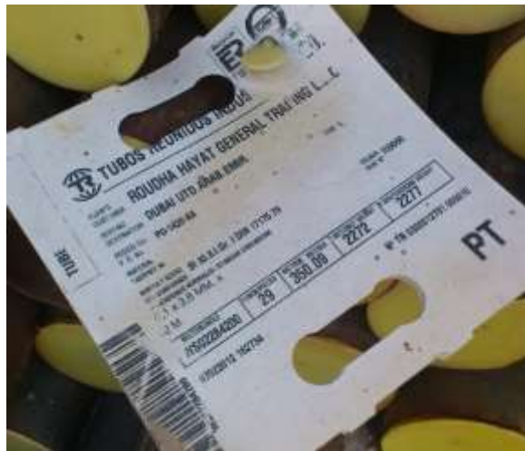
پلاک روی باندل برای برند TUBOS مترتال ST35.8 در استاندارد DIN17175
