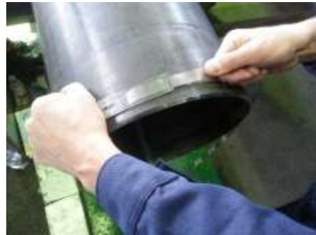
نحوه استفاده از متر کمربندی
