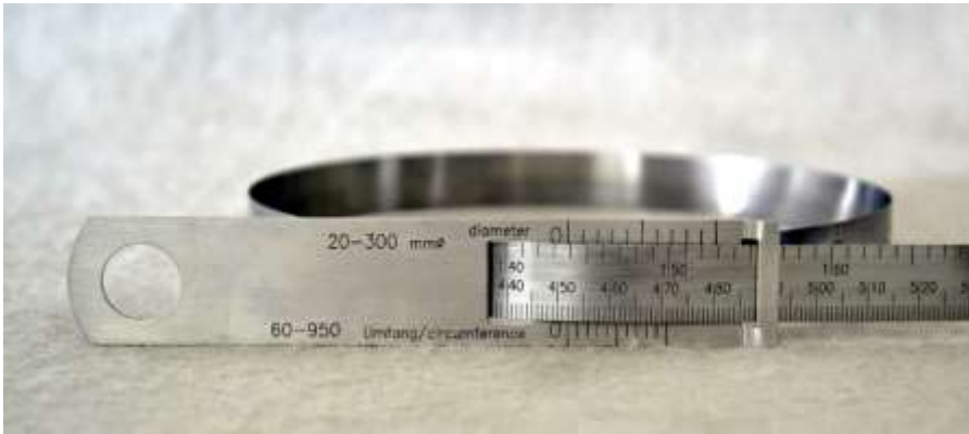
متر کمربندی مخصوص لوله (بالا قطر و پایین محیط لوله را به شما می دهد).
